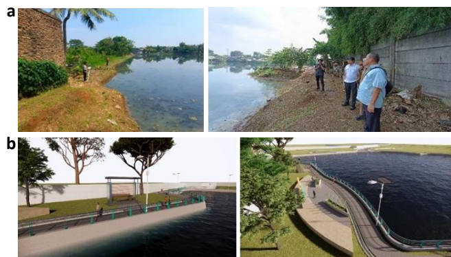
Gambar 5. (a) Gambaran eksisting dan (b) desain penataan perkuatan tepian Situ Rompong.
